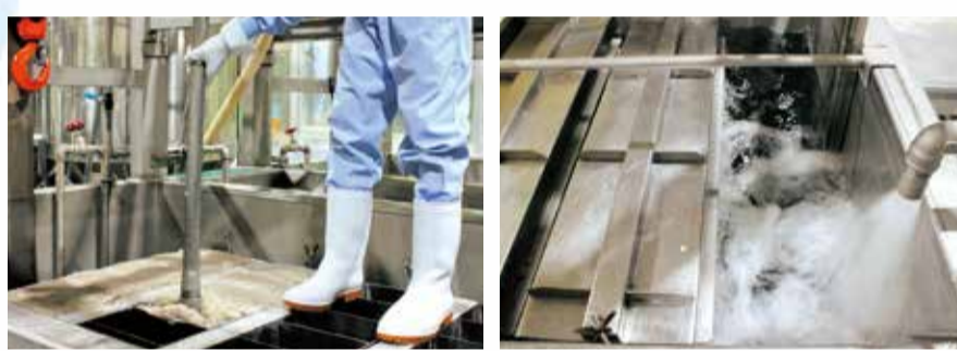
秋に収穫して冷凍されていたこんにやく芋をお湯につけ解凍します。1つずつ丁寧に水洗いしながら、ミキサーに投入します。
