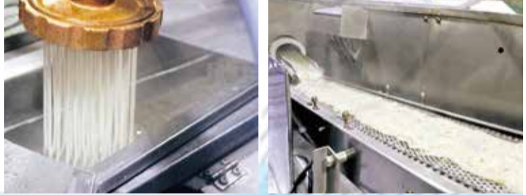
缶蒸しをする前の糊状の時に、細い穴に流し入れながら茹で、糸のように細いひも状にします。
